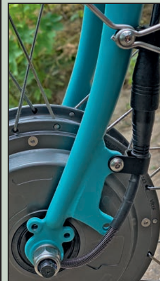
Motor mit Stromkabel und Magnet Stecker
