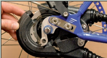
Hintere Linsenkopfschraube öffnen.
