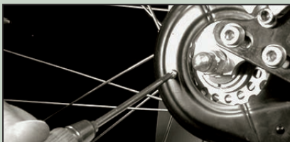
Hintere Linsenkopfschraube öffnen.
